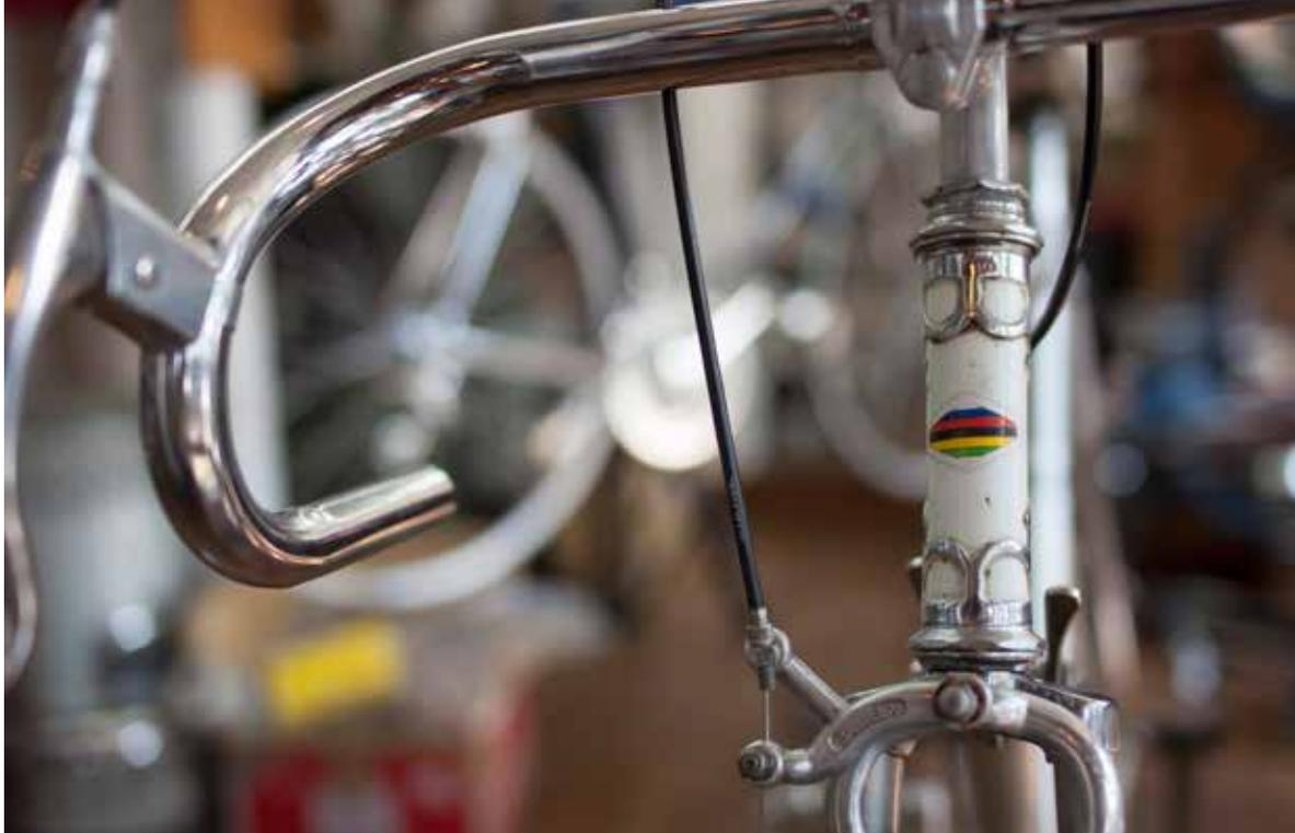
▲ヴィンテージ・ヴェロのフレームはクロモリが主。塗装やメッキもしっかりしているので、損傷が圧倒的に少ない。
