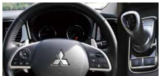
蓄電をコントロールする再生レベルセレクター(リボルブ式)と「バッテリーセーブモード」&「バッテリーチャージモード」スイッチ
